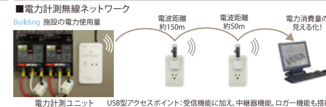
電力計測ユニット USB型アクセスポイント:受信機能に加え、中継機能、ログ機能も搭載
